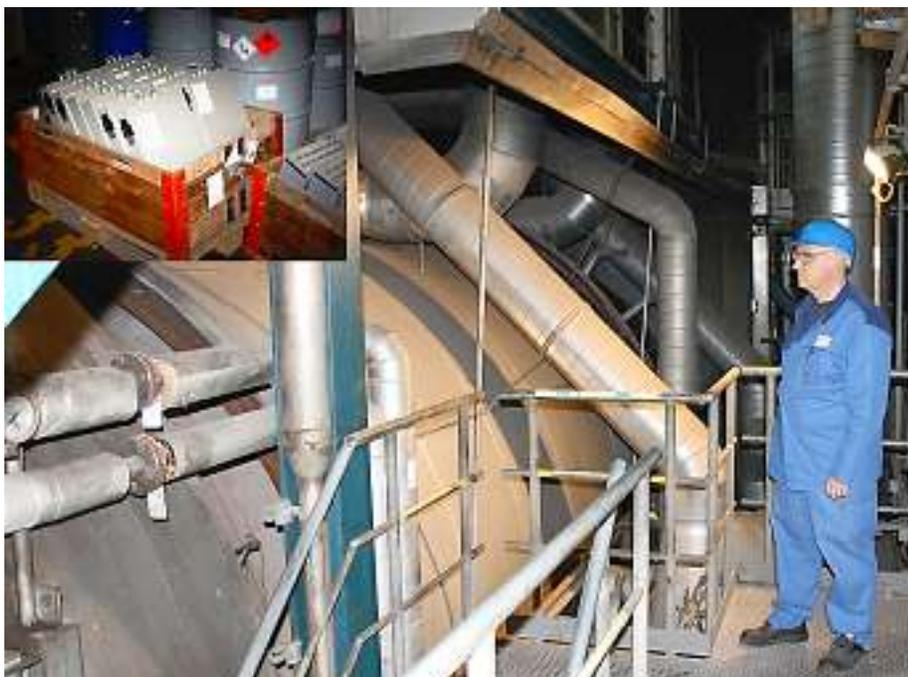
Betriebschemiker Rudolf Altermatt an dem 10 m langen Drehrohr, das innen zum Schutz vor der Hitze mit Steinen ausgekleidet ist. Hier werden auch PCB-haltige-Sonderabfälle verbrannt.
